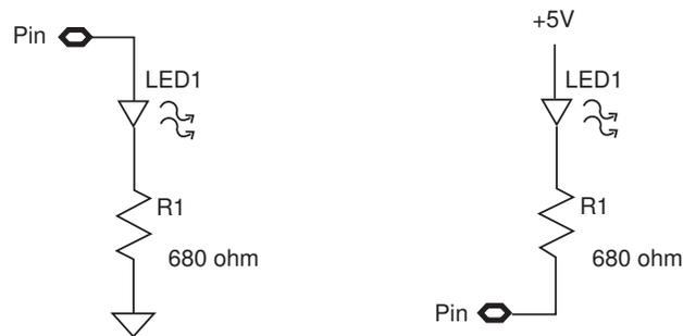
圖 6-4 LED 的電路
